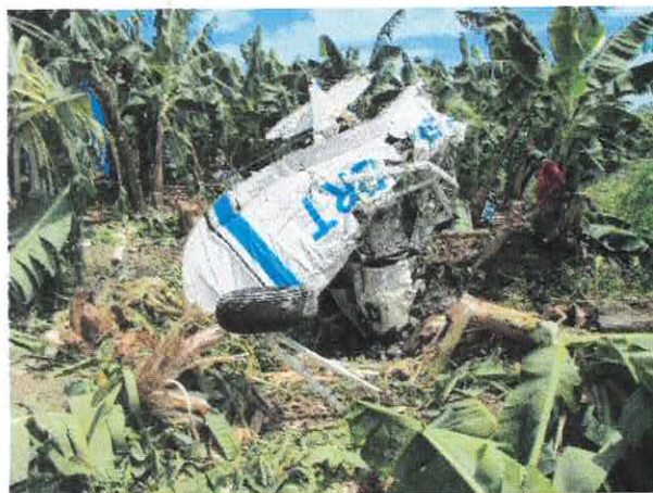
Fig. 2. Alas de la aeronave destruidas
