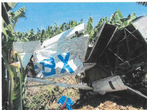
Fig. 1. Aeronave capoteada debido al impacto contra plataneros
