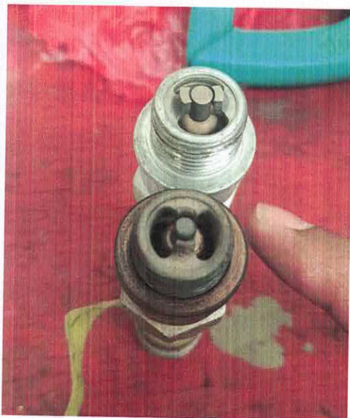
Fig. 7 Lado derecho bujía del motor izquierdo comparada con una bujía nueva, del lado izquierdo prueba de bujía
