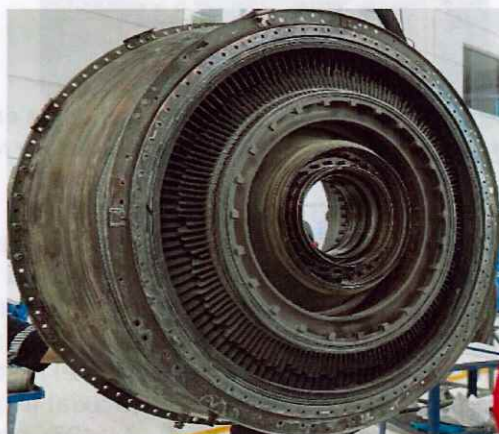
Fig. 1.16.1.5.1.f. Modulo Rotor/Estator de la Turbina de Baja Presión "LPT".
