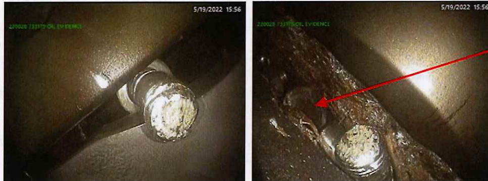
Fig. 1.16.1.5.1.c. Objetos Extraños reportados “FODs”, como rodamientos o dientes del Balero No. 3.
