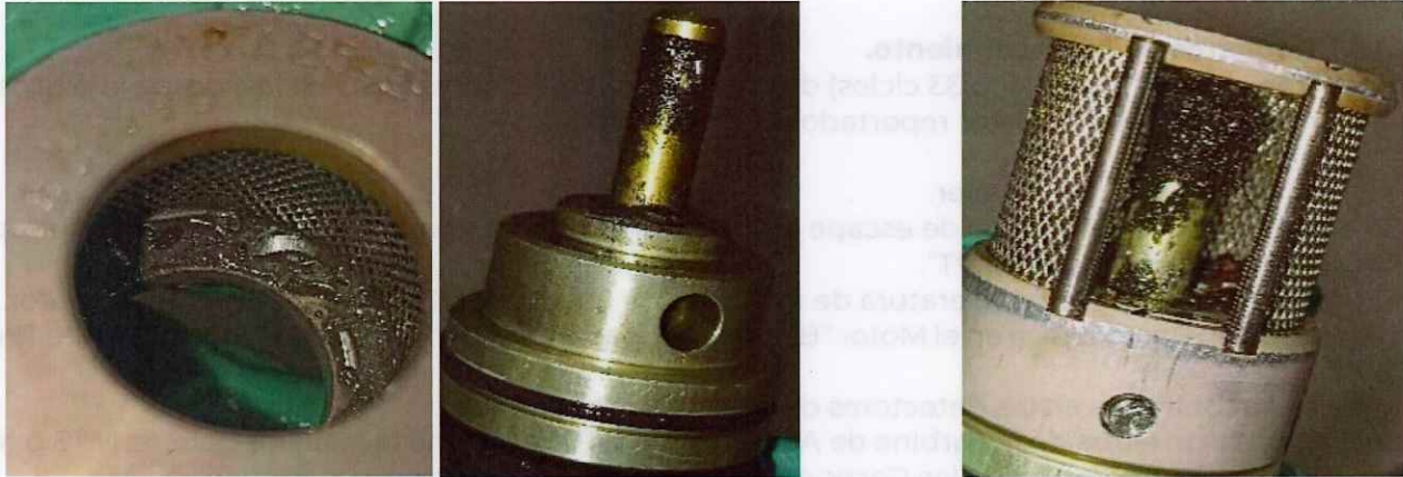
Fig. 1.16.1.5.1.b. En los carter delanteros y traseros con residuos sólidos.
