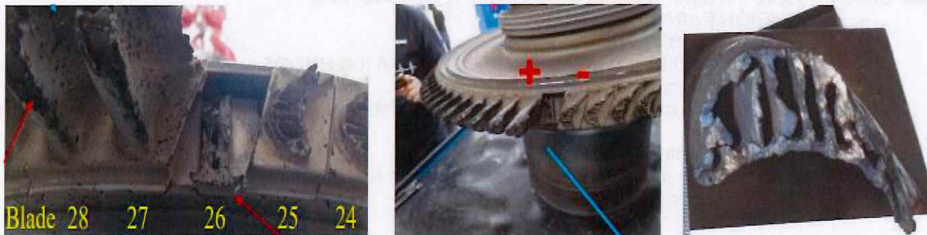
Fig. 1.16.1.5.1.g. Falla de raíz del alabe posición No. 26 en la 1 etapa de la Turbina de Alta Presión.
