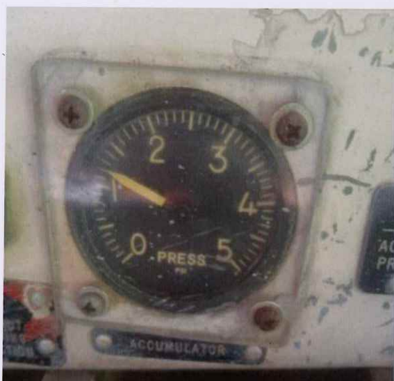
Indicador de botella del acumulador de hidráulico con indicación correcta 1200 psi de presión.
