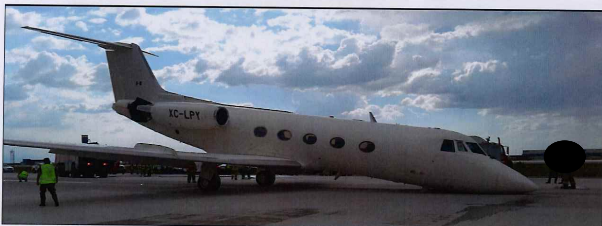
Daños a la aeronave marca Gulfstream modelo G-II, matrícula XC-LPY, pista del AIFA
