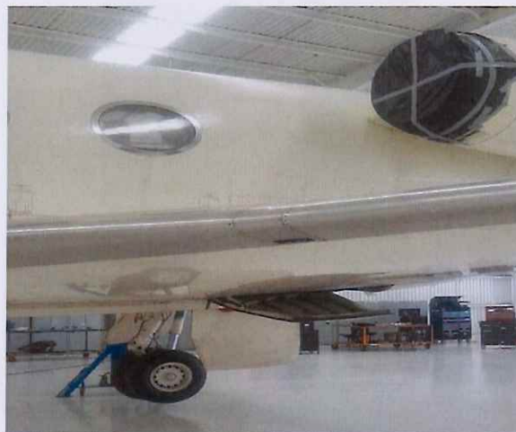
Tren principal izquierdo arriba y asegurado
