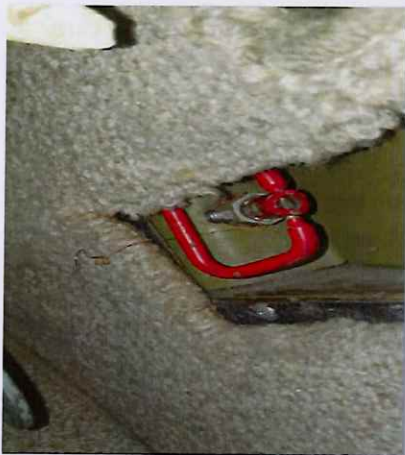
El "anillo-D" de la manija de vuelo está en posición normal (totalmente hacia abajo).
