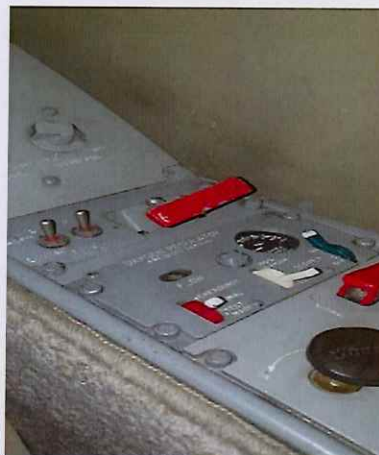
La manija en T del tren de aterrizaje de emergencia en posición normal de guarda
