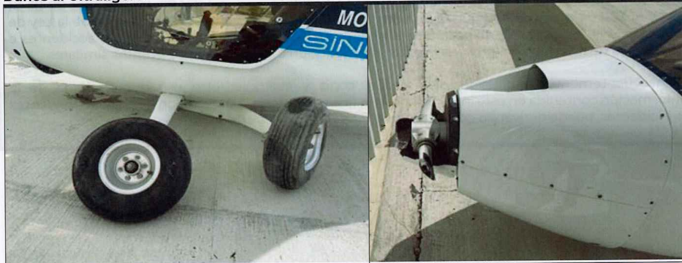
Fig. 2 Daños al tren de Aterrizaje como a la hélice por impacto contra el terreno.
