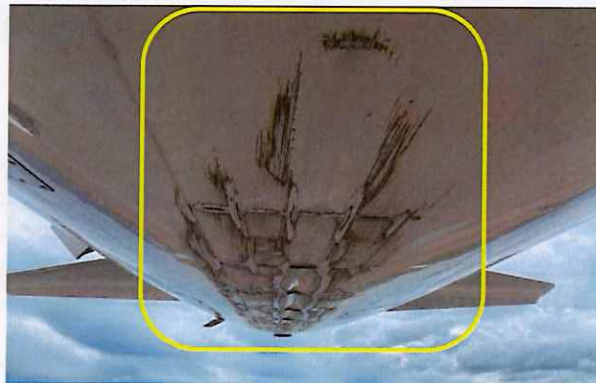
Fig.1.1.a. Daño en la piel inferior
