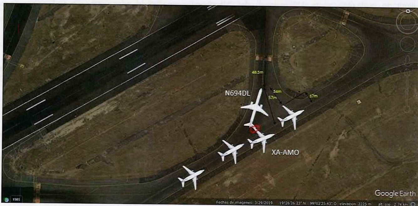
Fig. 2. Croquis ilustrativo de lo captado en el CCTV, que acusa que a las 21:02:03 UTC, se observa el desplazamiento por propio impulso del XA-AMO hacia la derecha del eje de rodaje "TWY D" con un rumbo de 1° y la aeronave N694DL sin movimiento.
