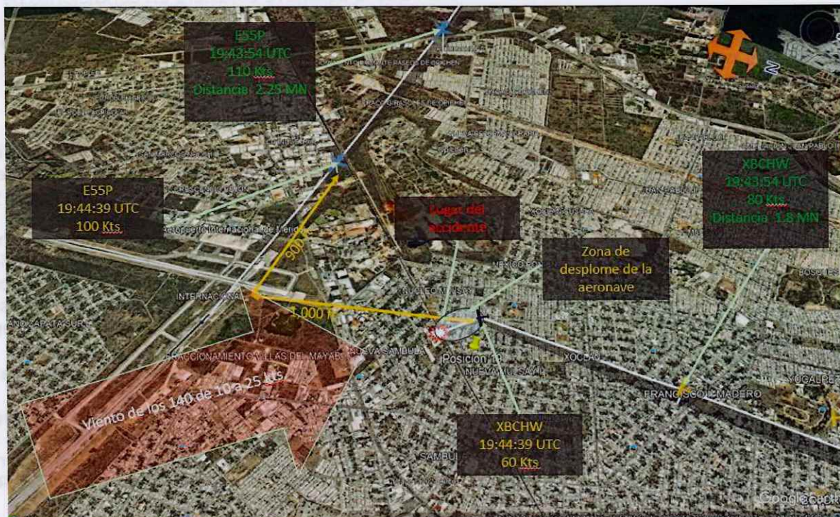
Fig.07 Secuencia de las trayectorias en aproximación de las aeronaves con el viento.
