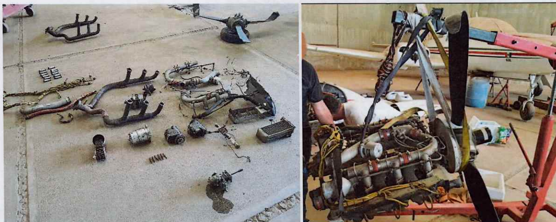
Fig. 03 Apertura de los Motores
