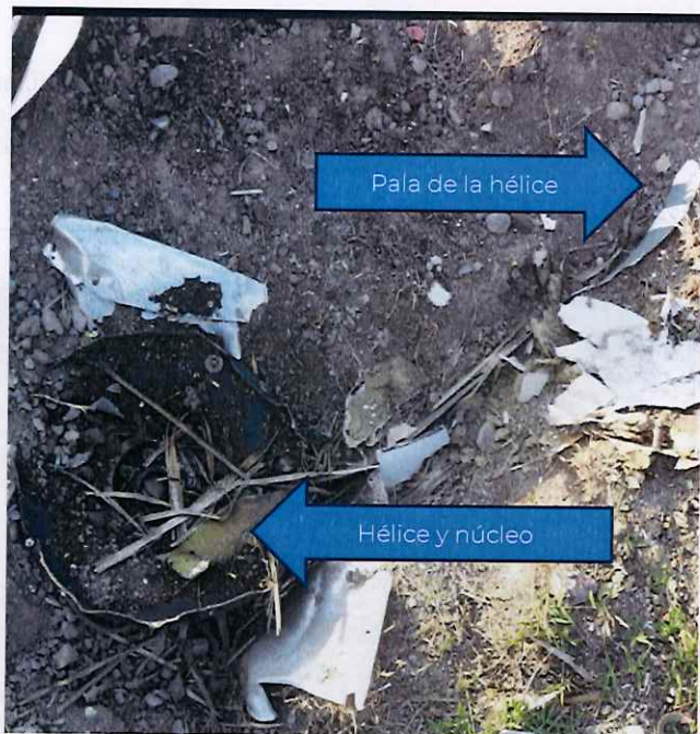
Hélice Izquierda dentro del suelo por el impacto
