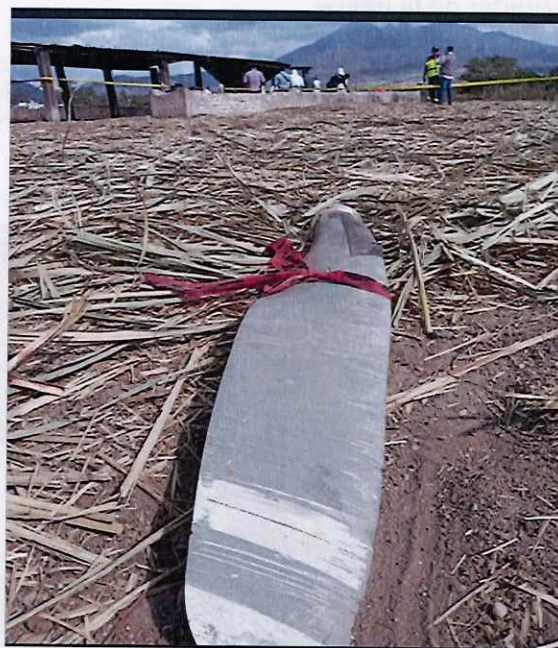
Pala de la hélice izquierda desprendidas por el impacto contra el terreno sin daños por estar girando
