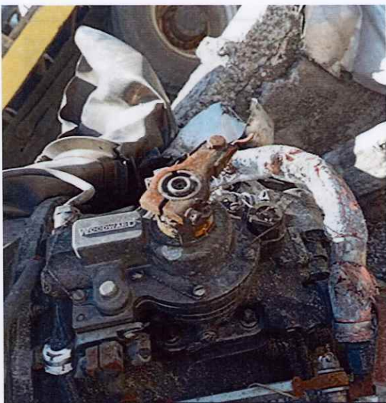
Gobernador del Hélice derecha en perfilado
