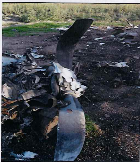
Hélice derecha en perfilado y unida al Motor
