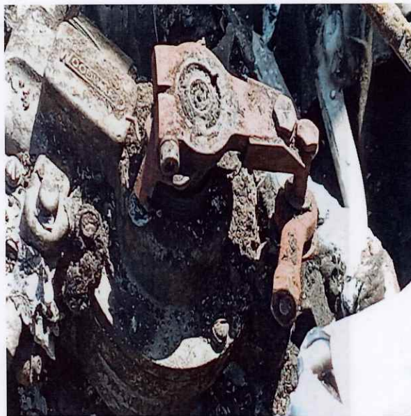
Gobernador de la hélice Izquierda en Perfilado
