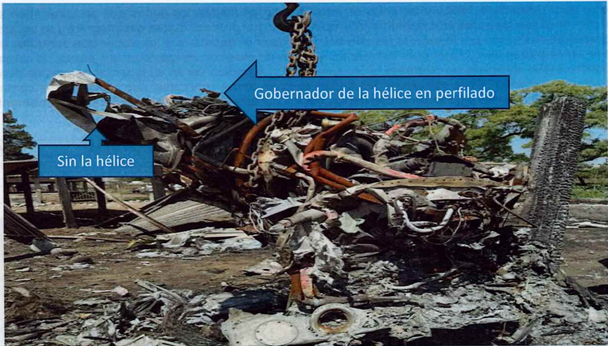
Remoción del motor izquierdo sin hélice del suelo.
