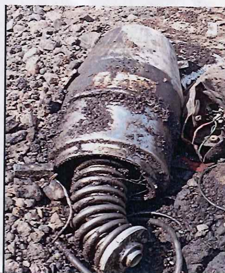
Sistema de retorno de perfilado de las palas
