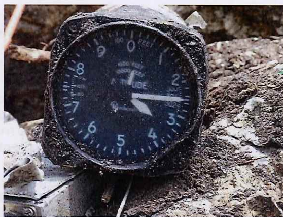
1.18.b. Altímetro, 3,230 ft (984m), 10.19 mb-30.09 in.hg (-48 metros)
