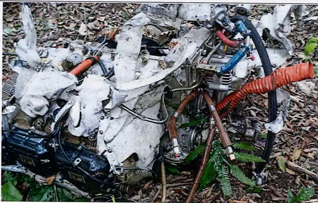
Motor con daños por impacto
