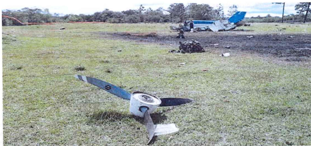
Fig. 2.- Hélice izquierda con daños en sus palas
