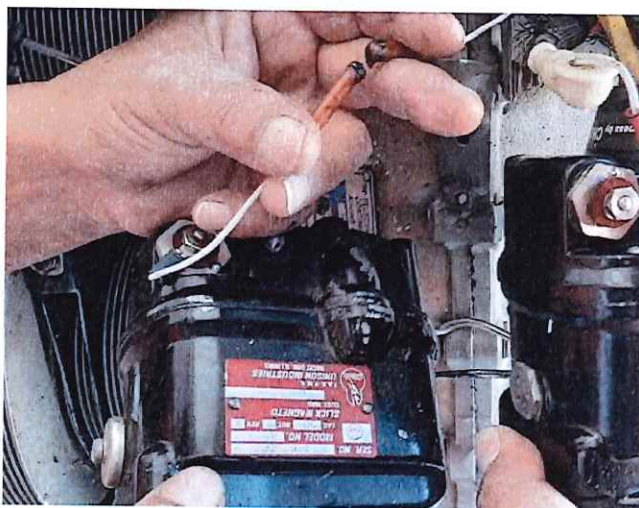
Fig. 8.- El cable a tierra del magneto del motor derecho se encontró quemado
