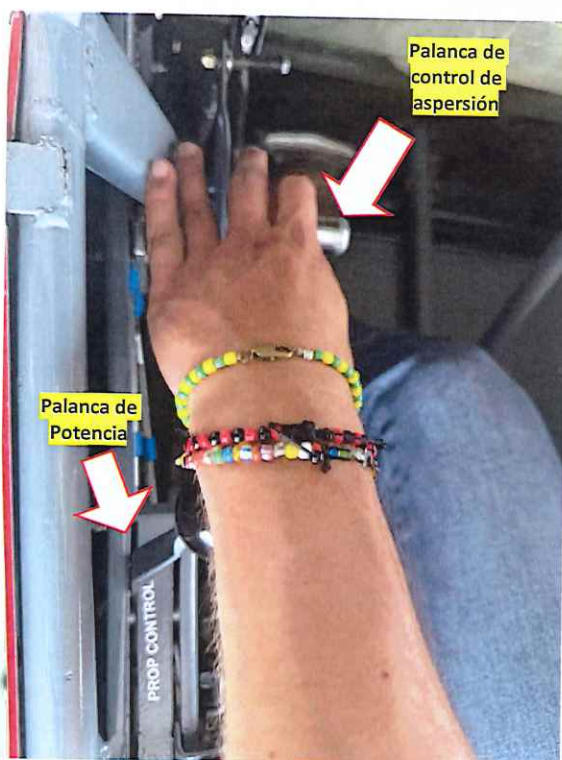
Imágenes 3 y 4. Palancas de potencia y control de aspersión
