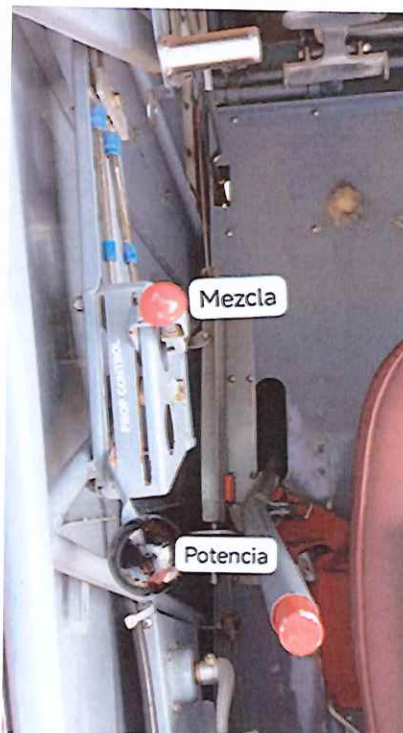
Imágenes 3 y 4. Palancas de potencia y control de aspersión
