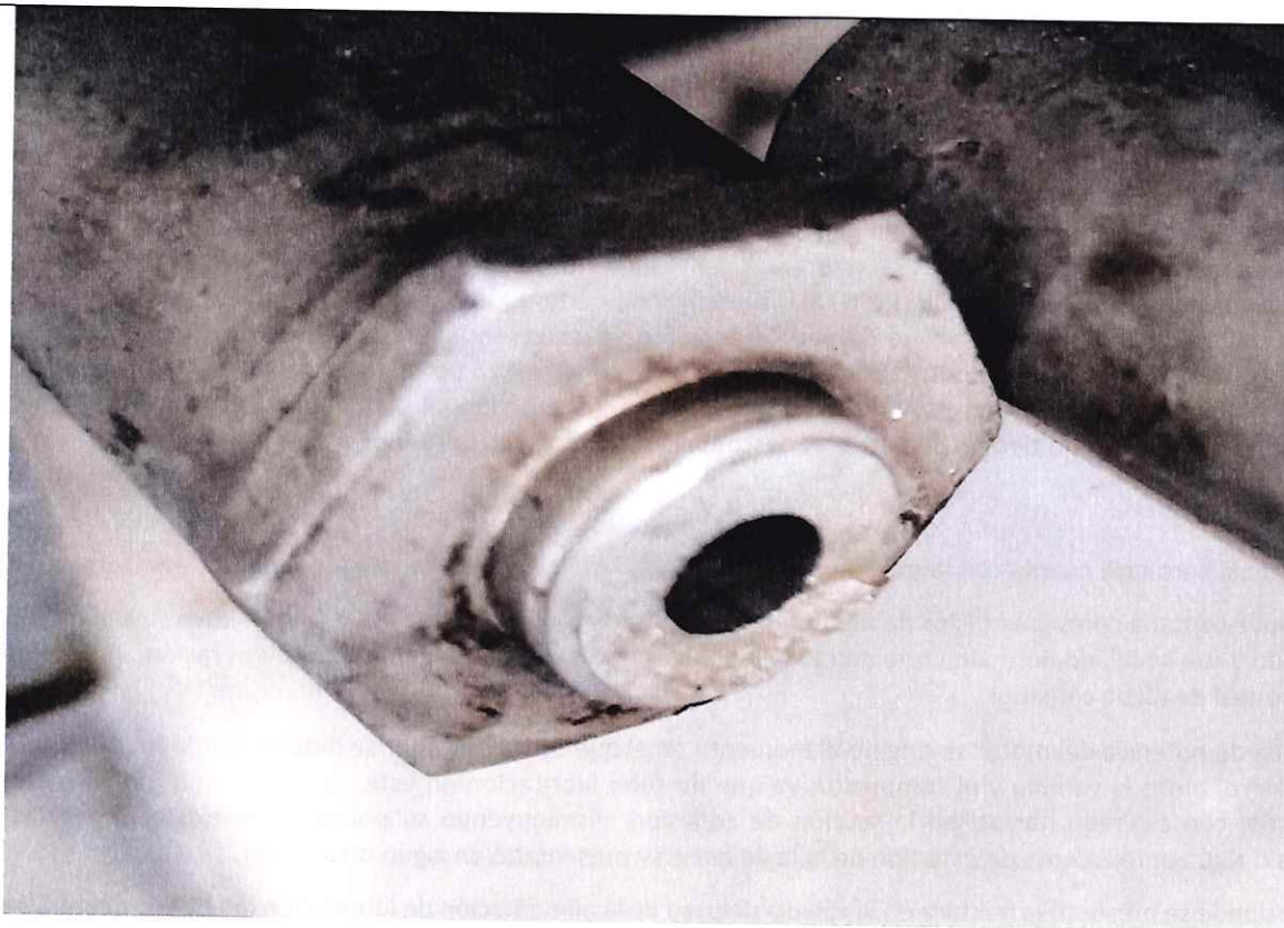
Foto 1.- Acercamiento a la sección dañada, apreciándose la fatiga del material
