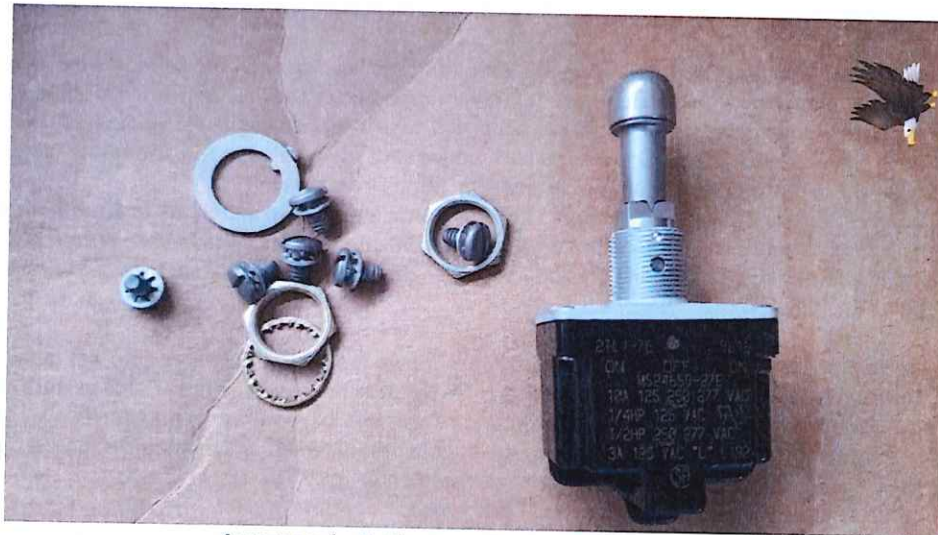
ILUSTRACIÓN 2. SWICH DE TEST DE TEMP LIMITER.
