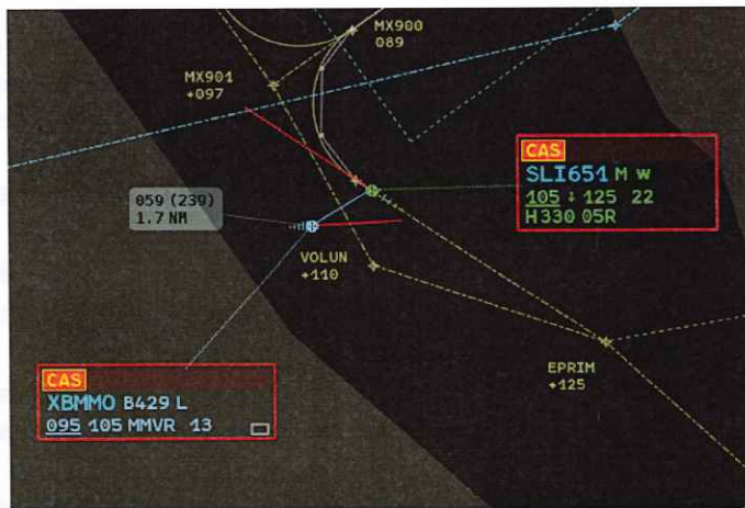
ILUSTRACIÓN 5. 20:47:28 UTC RESOLUCIÓN RA TCAS DEL VUELO SLI651
