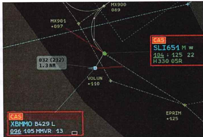
ILUSTRACIÓN 5. 20:47:28 UTC RESOLUCIÓN RA TCAS DEL VUELO SLI651
