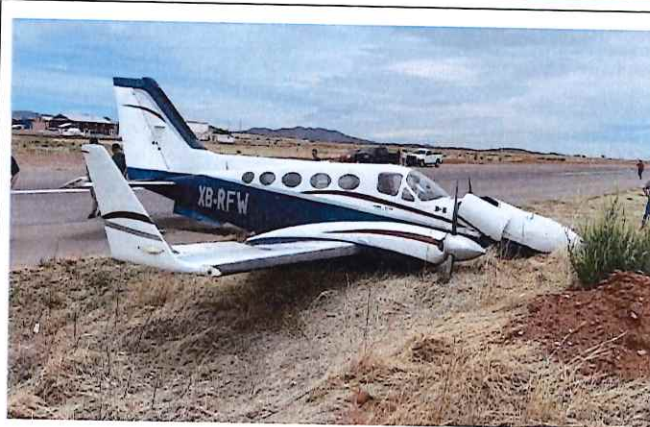
Ala Derecha con daños leves
