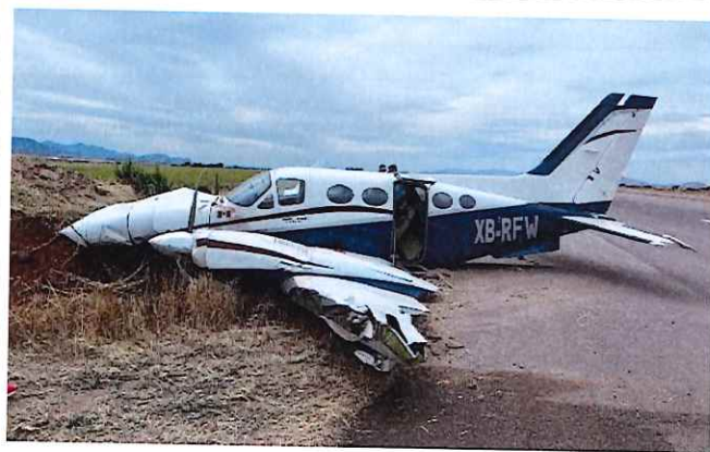
Ala izquierda con daños graves
