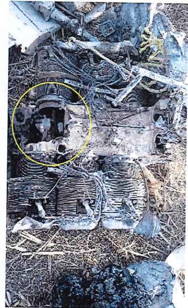
1.6.e. Daños en el cigüeñal a la altura de los cilindros 1 y 2.
