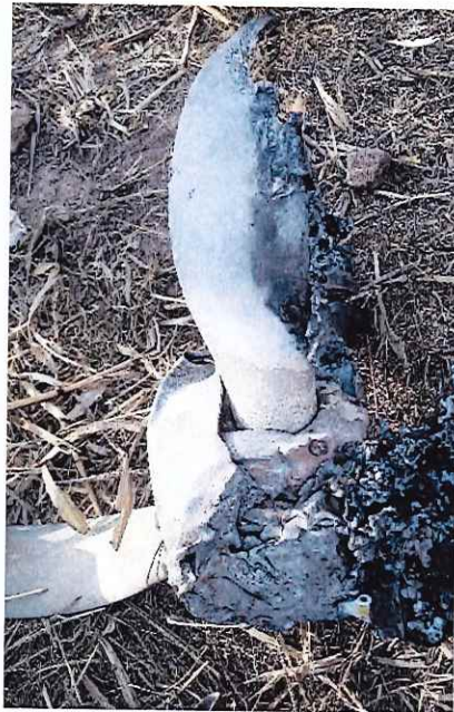
1.6.d. Daños por spinner por impacto de las tres palas de la hélice
