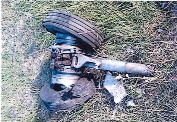
Ruedas y masas de los frenos del tren de aterrizaje
