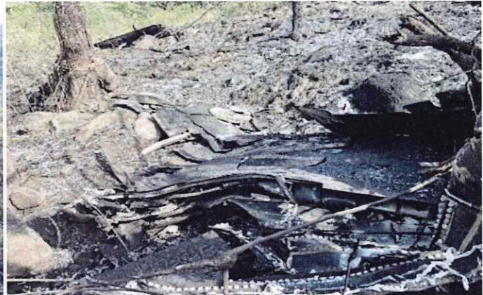
Vista de los restos del fuselaje de la aeronave el cual esta destruido por impacto e incendio
