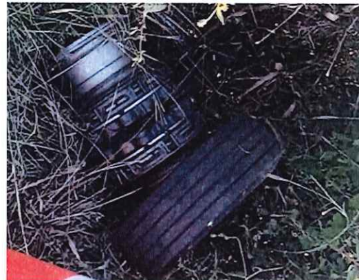
Ruedas y masas de los frenos del tren de aterrizaje
