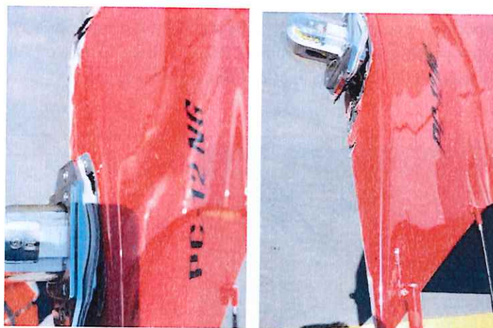
ILUSTRACIÓN 2 DAÑOS EN LA AERONAVE XA-PTS
