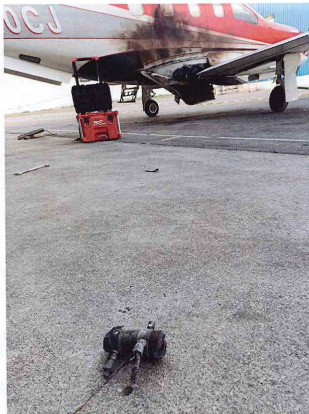
Fig. 2. Daños en el área de la botella del sistema de oxígeno.
