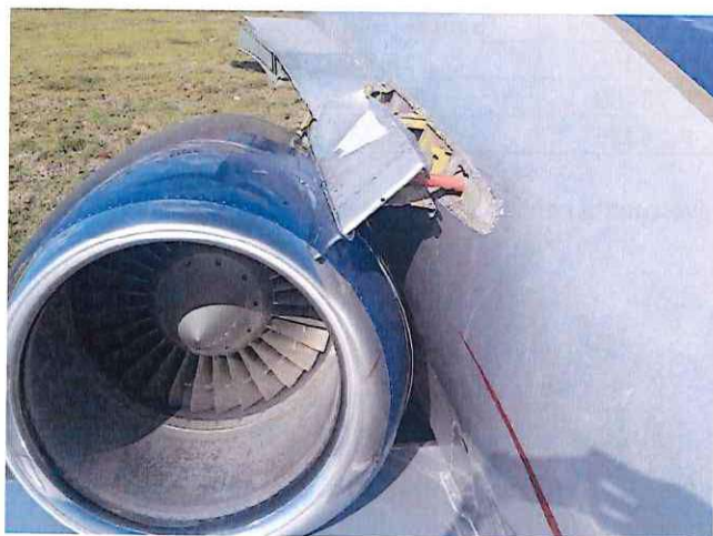
1.3.1 Desprendimiento del motor
