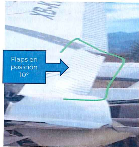
Fig. 4 Posición del Compensador y Flaps en el lugar del accidente.
