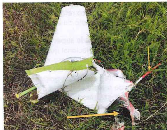
Fig. 1.6.1.2 Estabilizador vertical y sección trasera del botalón
