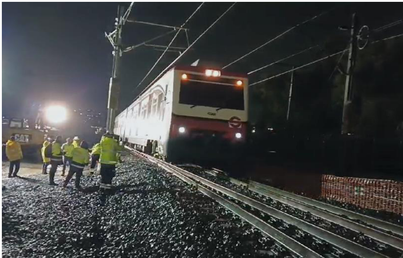
Prueba a baja velocidad con paso de tren Suburbano Lechería – AIFA.
