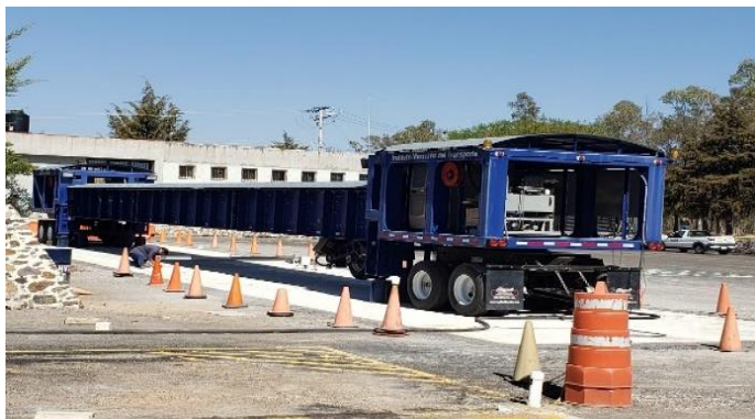
Figura 2. Tramo de Prueba con el Simulador de Vehículos Pesados (HVS-IMT)
