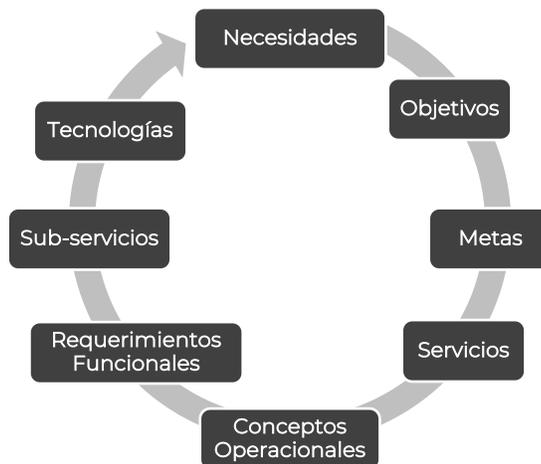
Figura 3. Esquema de trazabilidad para la planeación y diseño de proyectos ITS. SCT, 2010
