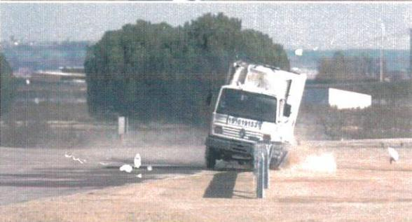
Los ensayos de impacto realizados han sido evaluados de acuerdo con los criterios establecidos en MASH. El comportamiento del SISTEMA DE CONTENCIÓN TL4 MASH "BLIDTL4C2-MASH" es evaluado en base a tres factores: adecuación estructural, riesgo para los ocupantes y trayectoria del vehículo después del impacto.
