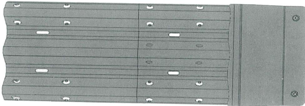
Fig.11: Ejemplo de conexión de tres a la barrera de Nueva Jersey
