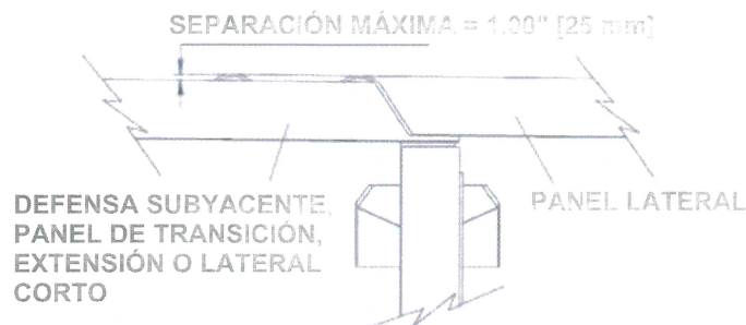
Figura 35 Separación entre paneles laterales
