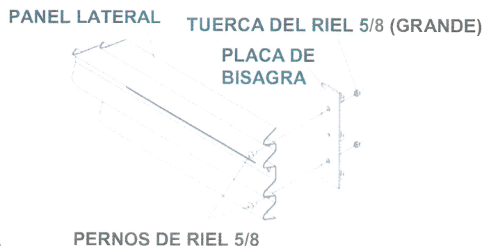
Figura 25 - Placa de bisagra al panel
