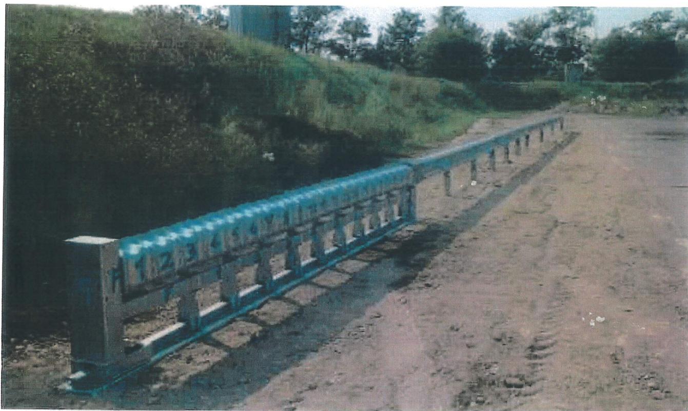
Fig. 2: Prueba de choque del tratamiento de terminal de Ermes MASH TL-3 con conexión a la barrera de seguridad
