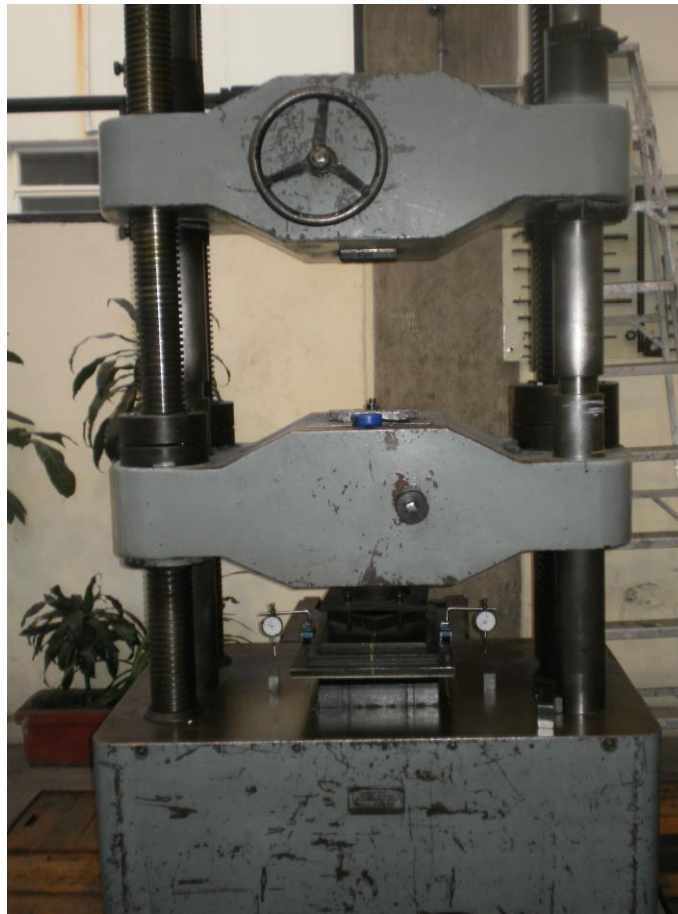
Figura 4.9 Dispositivo para el ensaye de placas o apoyos integrales de neopreno.
