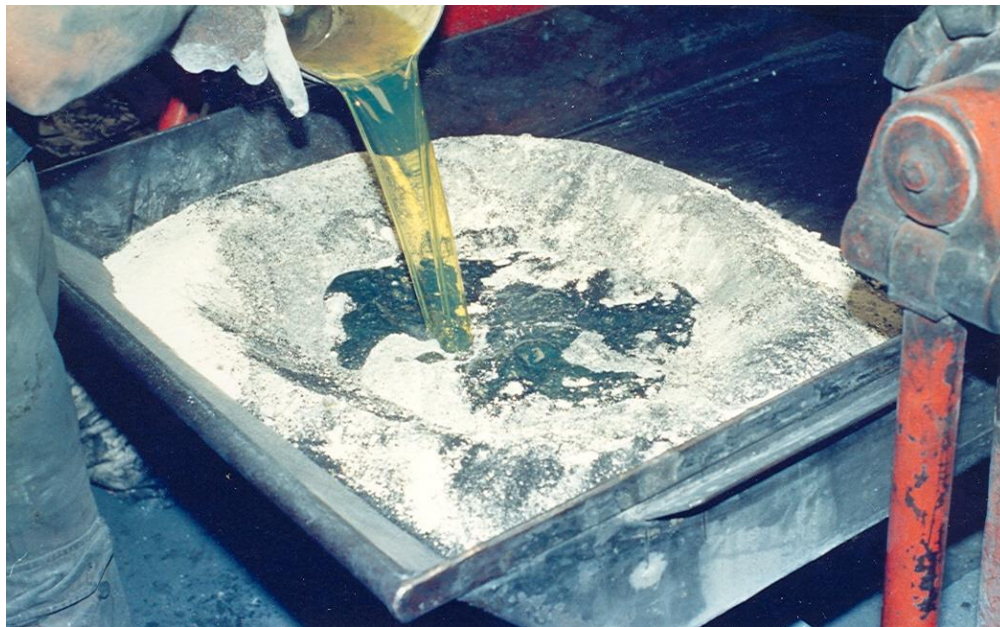
Figura 2.4 Preparación de la carga compuesta de caolín, negro de humo y aceites.
