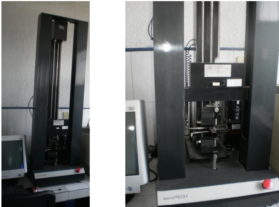
Figura 4.1 Tensiómetro o máquina para efectuar prueba de tensión.
