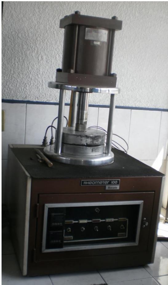
Figura 2.17 Reómetro para determinar tiempo y temperatura de vulcanización.
