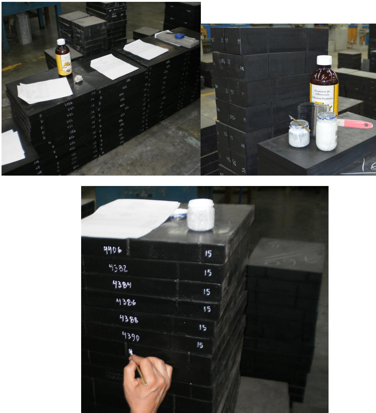
Figura 5.2 Marcado de apoyos integrales de neopreno.
