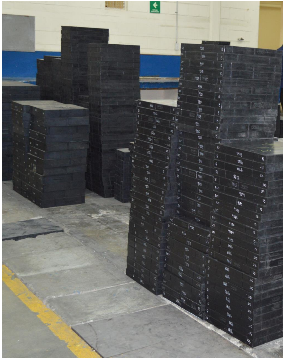
Figura 5.9 Apoyos de neopreno ensayados listos para su traslado a obra.
