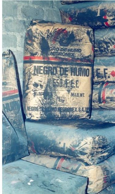
Figura 2.5 Negro de humo para la elaboración del neopreno crudo.
