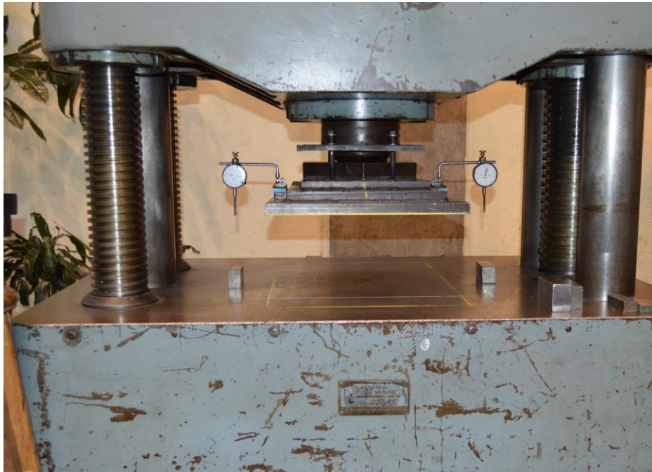
Figura 4.8 Máquina de compresión para el ensaye de placas o apoyos integrales de neopreno.
