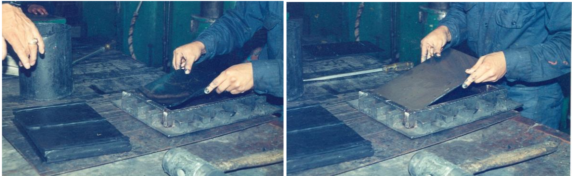
Figura 2.11 Colocación de las capas de neopreno y las placas de acero en el molde para formar el apoyo integral.
