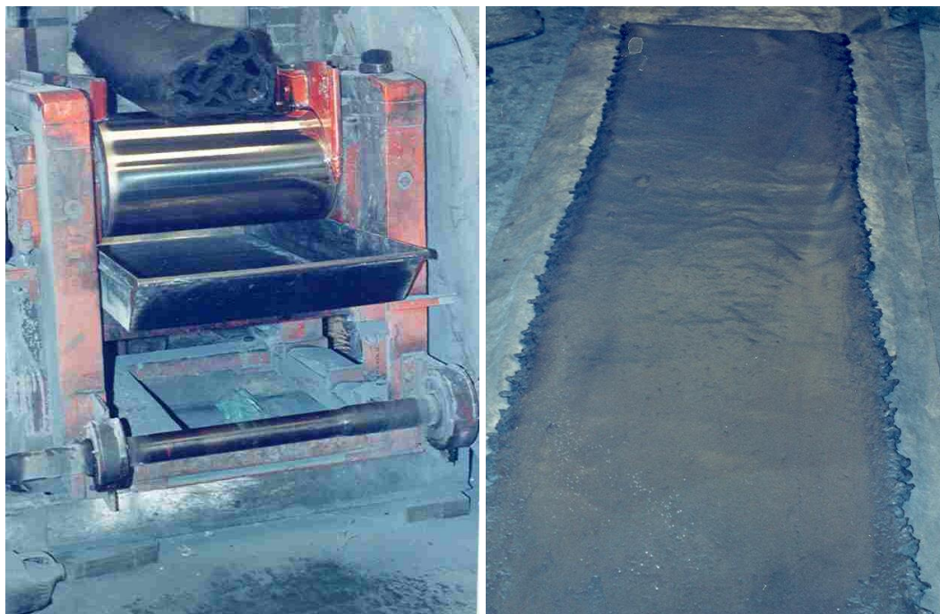
Figura 2.8 Proceso de amasado de todos los ingredientes incorporados y obtención del neopreno crudo.
