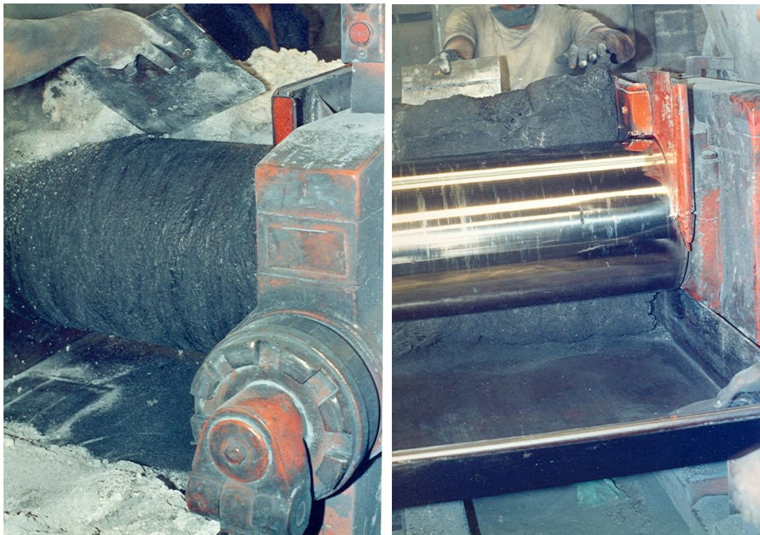
Figura 2.7 Incorporación de la carga y aplicación del proceso de amasado.
