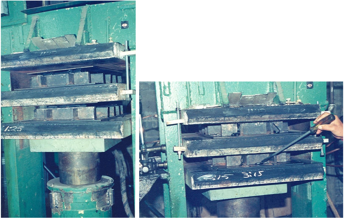
Figura 2.14 Vulcanización de los apoyos integrales de neopreno mediante calor y presión.
