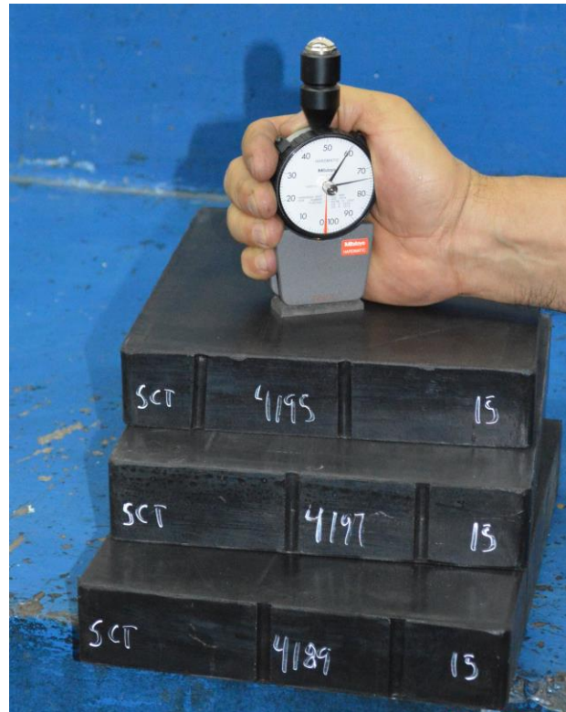
Figura 5.4 Determinación de la prueba de dureza.
