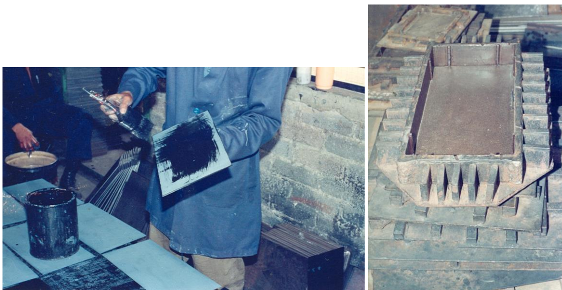
Figura 2.9 Preparación de las placas de acero intermedias y el molde.
