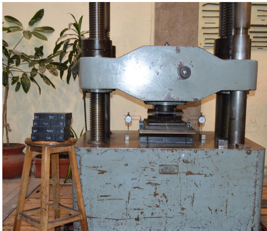
Figura 5.5 Determinación de la deformación unitaria de apoyo integral de neopreno.
