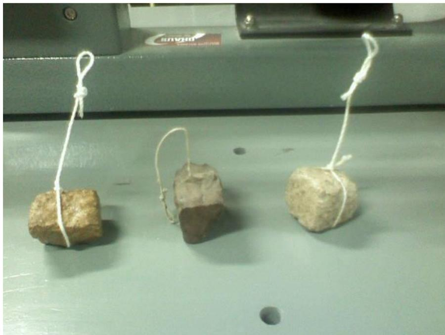
Figura 5.5 Muestras de suelo inalteradas cubiertas con una capa de parafina.
