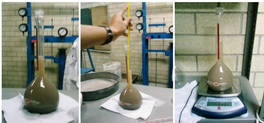
Figura 5.6 Ejecución de la prueba de densidad de sólidos
