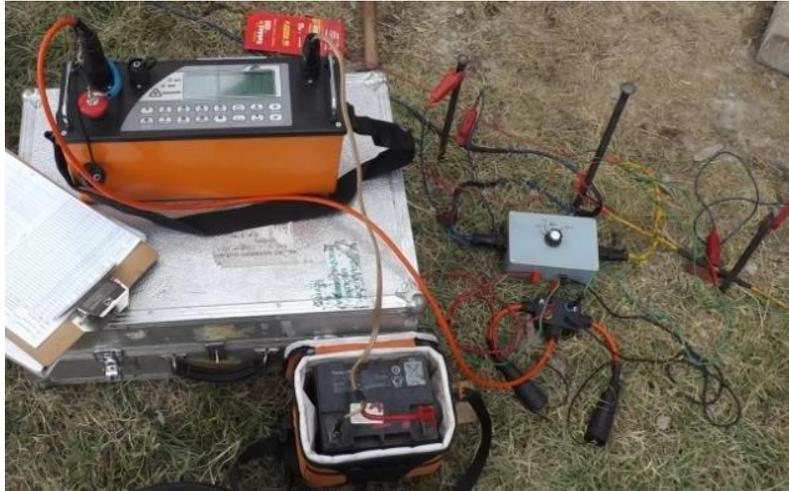
Figura 3.19 Equipo de resistividad utilizado en la toma de registros eléctricos, y dispositivo tetraelectrónico en arreglo Schlumberger.
