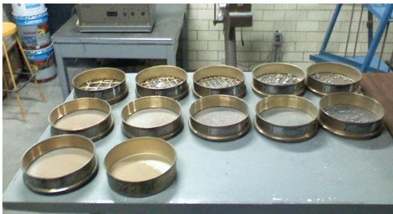
Figura 5.4 Mallas utilizadas para el cribado durante la ejecución de la prueba de Granulometría.
