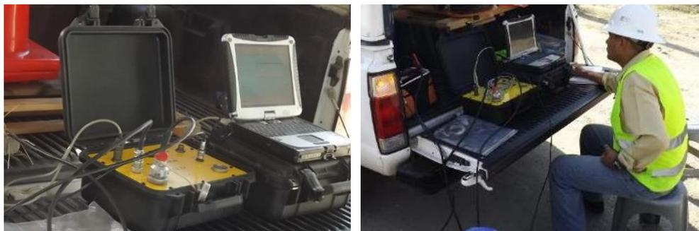
Figura 3.17 Sismógrafo utilizado comúnmente para los Tendidos de Refracción Sísmica.
