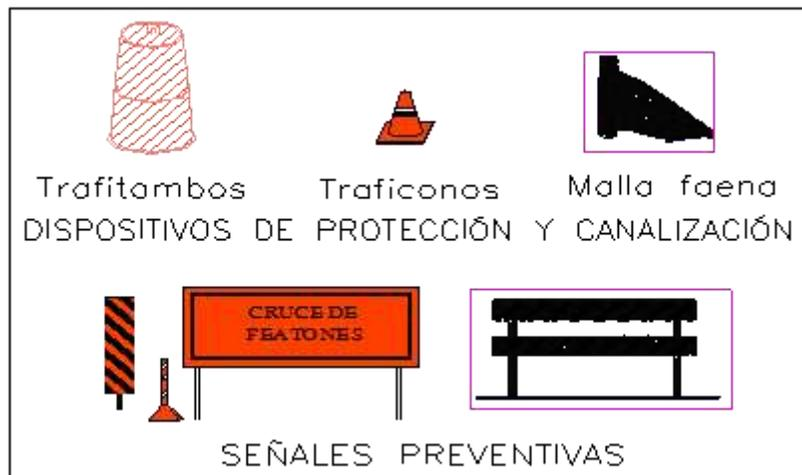
Figura 64.- Dispositivos y señalamientos de obras
