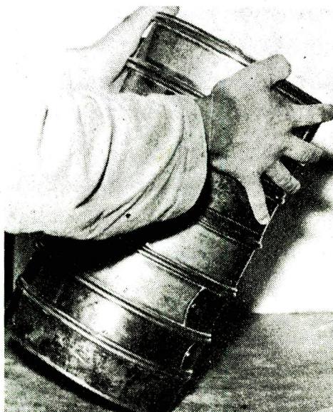
Figura Núm. 31. Disposición de las mallas por efectuar el cribado del material que pasa la malla Núm. 4.75.
