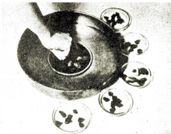
Figura Núm. 30. Colocación de los agregados en la charola, sumergida en el baño.
