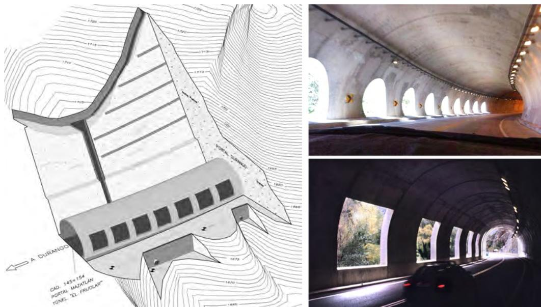
Figura 10.2. Túneles falsos con ventanas hacia el valle.
