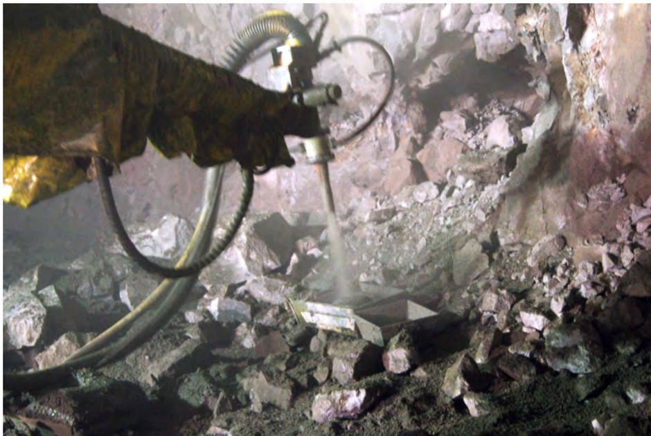
Figura 14.2 Obtención de muestras de concreto lanzado para ensayos en laboratorio.
