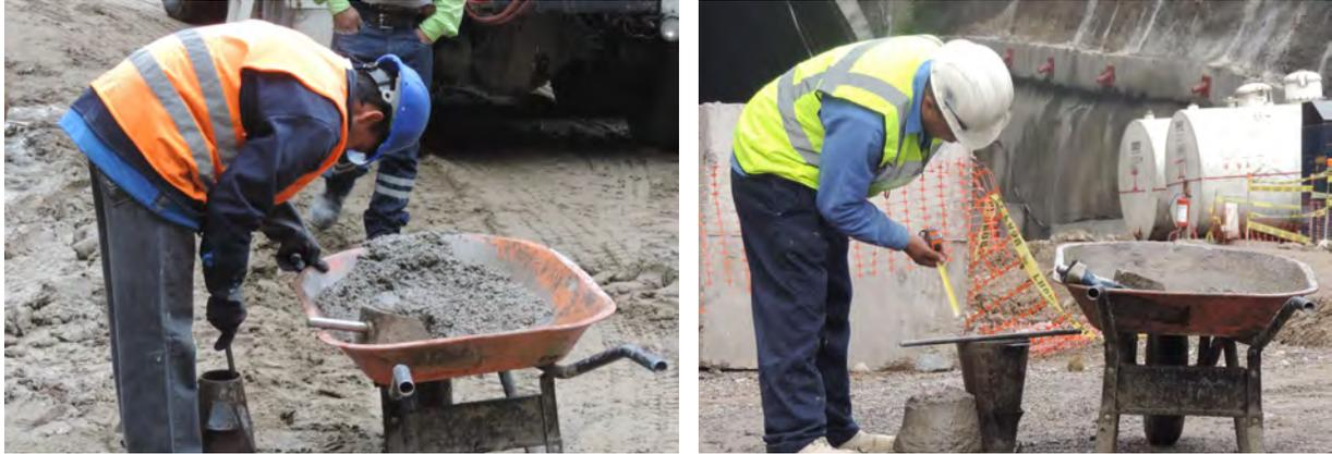
Figura 14.4. Procedimiento de medición de revenimiento en obra.
