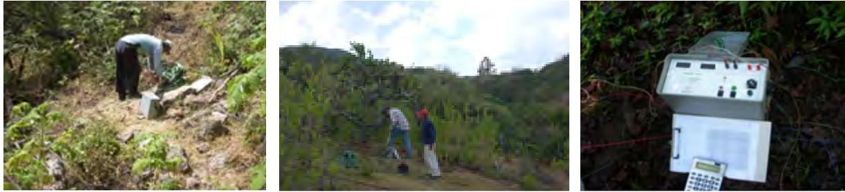
Figura 3.18. Serie de fotos, que muestran actividades durante la ejecución de SEV'S y foto que muestra el resistímetro y transmisor de corriente eléctrica utilizados.
