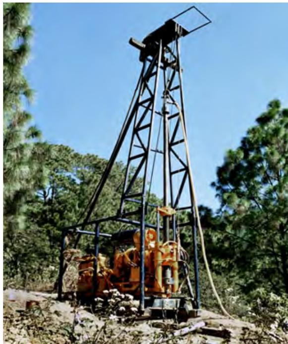
Figura 3.23. Ejecución de sondeos mediante equipo pesado.
