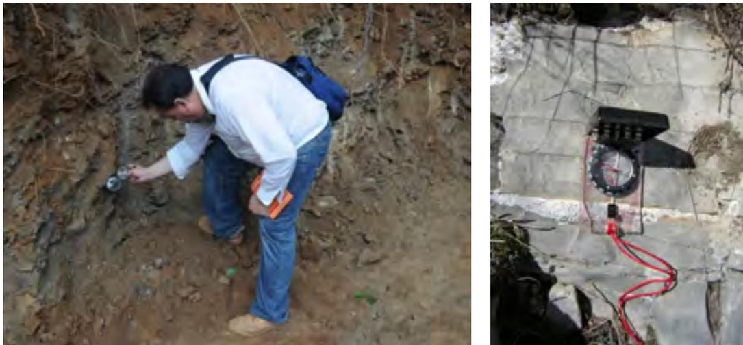
Figura 3.6. Levantamiento geológico estructural en discontinuidades.
