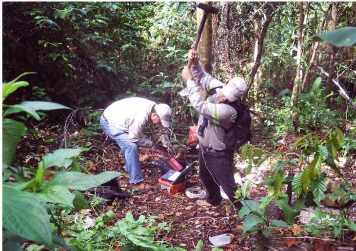
Figura 3.12. Ubicación de un punto de tiro (PT3) durante la ejecución de un tendido sísmico.
