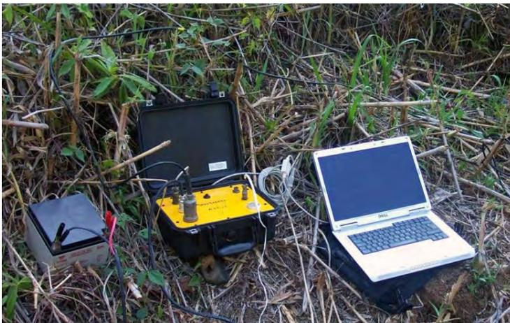
Figura 3.13. Sismógrafo Geometrics ES-3000, laptop y batería utilizados para la ejecución de los tendidos de refracción sísmica.
