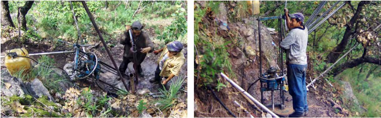
Figura 3.22. Ejecución de sondeos mediante equipo ligero.
