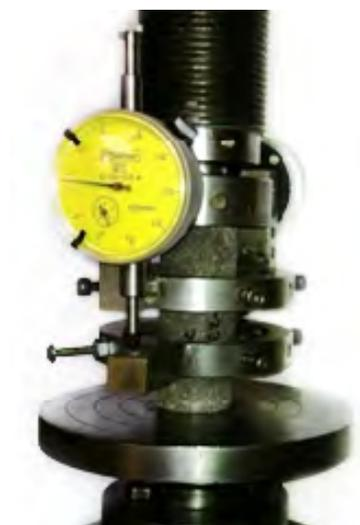
Figura 4.1. Prueba de compresión uniaxial con medición de deformación en equipo simple de 50 ton.
