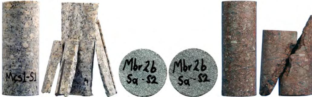
Figura 4.4. Ejemplos de probetas sanas o sin defectos litológicos, antes y después de ser ensayadas.
