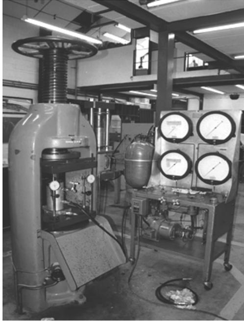
**Figura 4.2. Equipo para ensayos triaxiales con prensa Amsler y célula triaxial tipo Hoek. Laboratorio de la Comisión Federal de Electricidad, México.**
