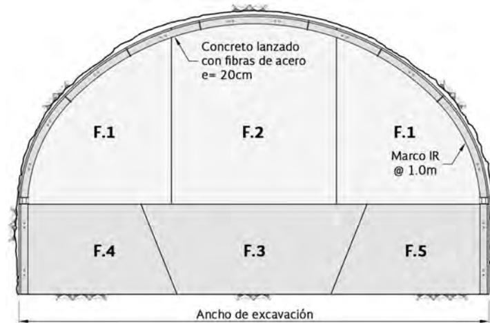
Figura 4.36. Esquema constructivo para la Condición Geotécnica D <sup>(2)</sup>.
