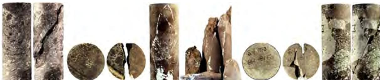
Figura 4.5. Ejemplos de probetas heterogeneas o con defectos litológicos, antes y después de los ensayos.
