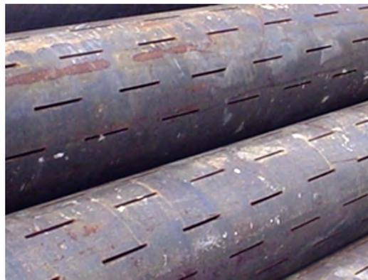
Figura 8.34. Tubería de acero ranurada.
