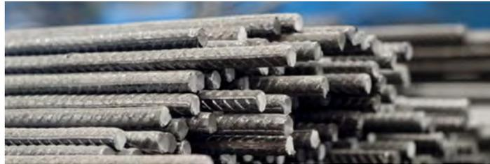
Figura 8.46. Barras corrugadas de acero de refuerzo convencional. Fuente: Aceros Titán.
