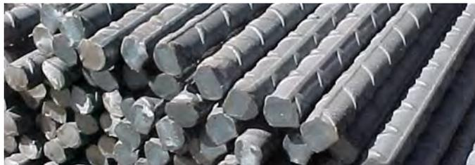
**Figura 8.41. Barras corrugadas de acero de refuerzo convencional.**
