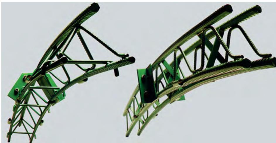
Figura 8.24. Armaduras para marcos de celosía: ejemplo con 3 y con 4 barras principales.
