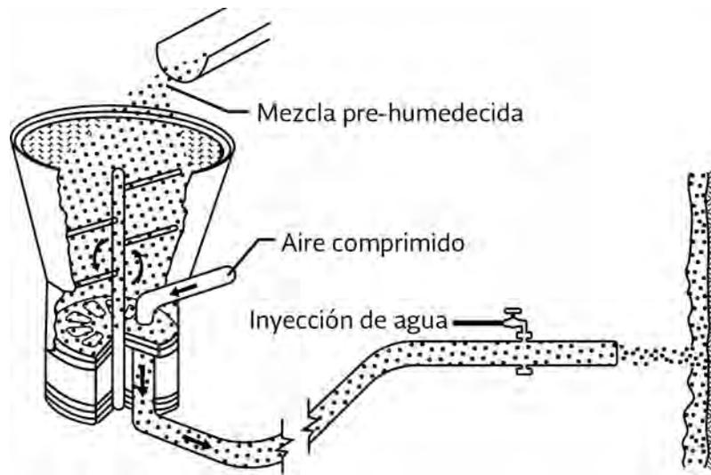
Figura 8.4. Esquema de la vía seca, a partir de Mahar et al. (1975). A partir de Hoek (2000).
