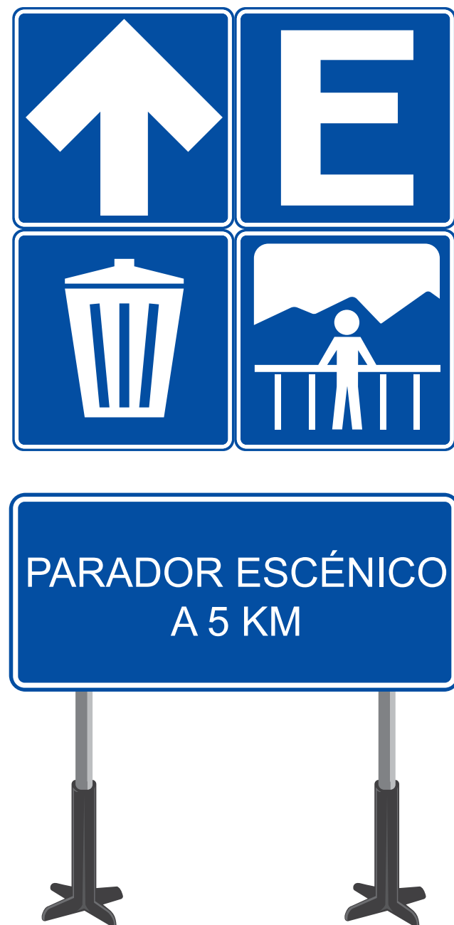
Figura 5.9.- Conjunto modular con tablero adicional de señales turísticas y de servicios.
