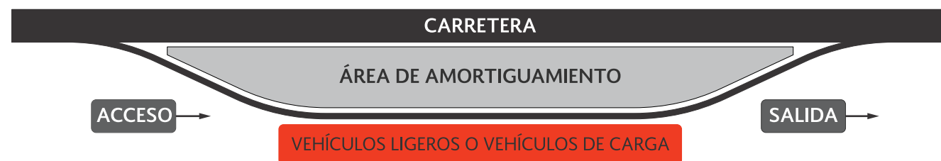
Figura 4.1.- Zonificación de parador de emergencia.
