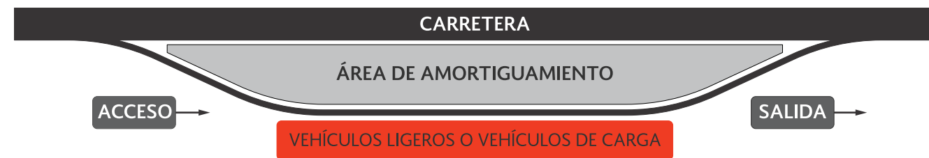
Figura 4.34.- Funcionamiento del parador de emergencia.
