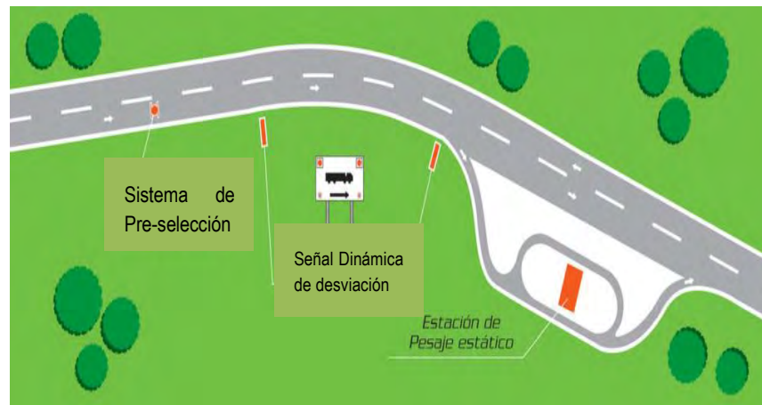
F-20 Diagrama de Estación para Pesaje Selectivo
