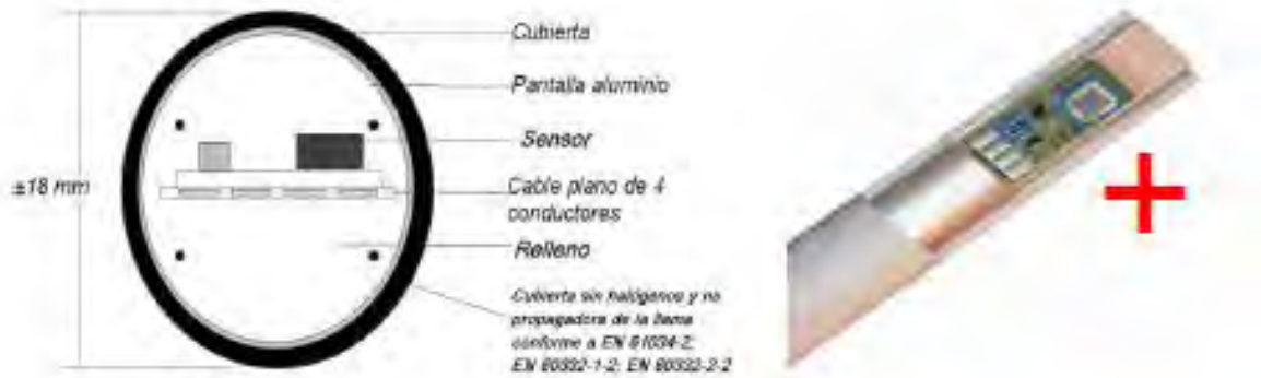
F-62 Diagrama de tecnología LISTEC para detección de incendios
