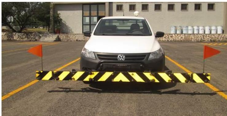
*Figura 2. PERFILÓMETRO LÁSER, para la medición del IRI*
