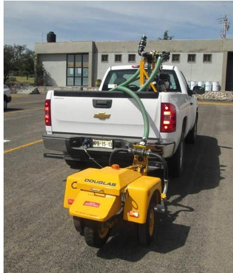
*Figura 3. MU-METER MK6, para la medición de fricción*
