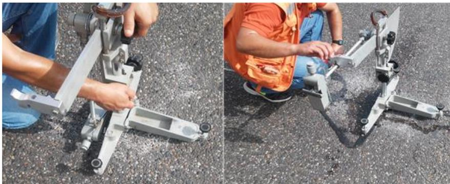
*Figura 4. PÉNDULO BRITÁNICO, para mediciones de fricción.*
