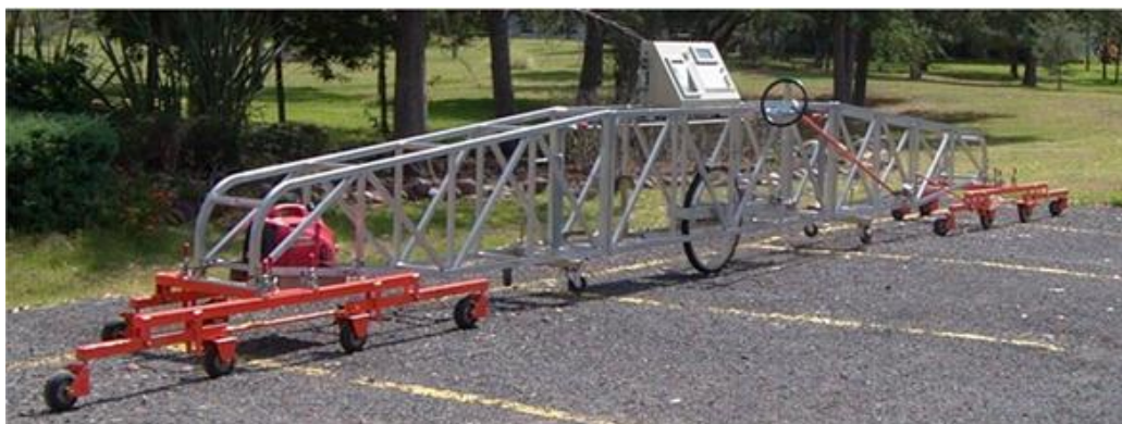
Figura 1. PERFILÓGRAFO TIPO CALIFORNIA, para la medición de IP
