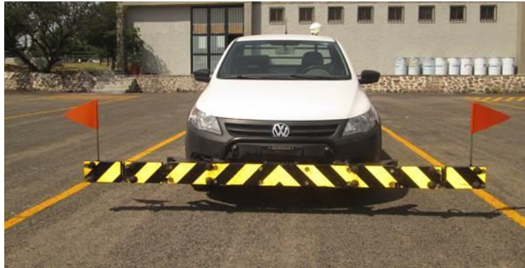
Figura 2. PERFILÓMETRO LÁSER, para la medición del IRI
