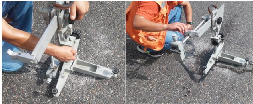
Figura 4. PÉNDULO BRITÁNICO, para mediciones de fricción.
