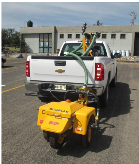
Figura 3. MU-METER MK6, para la medición de fricción
