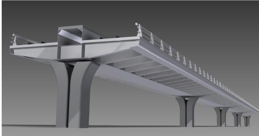
Figura 9 Render arquitectónico de estructura de viaducto elevado
