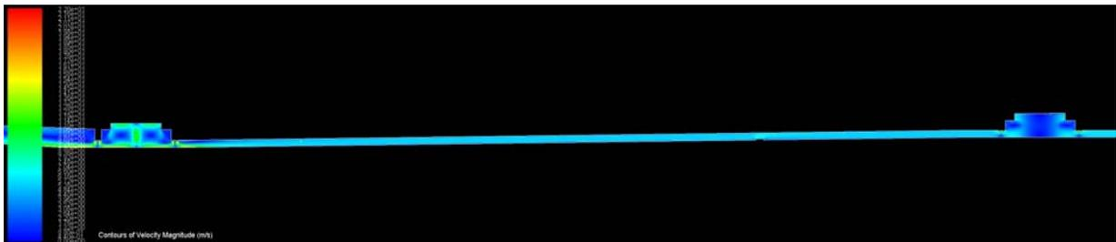
Contornos de distribución de velocidad a lo largo del túnel. Se observan las dos estaciones, la de la izquierda está en modalidad de inyección y la de la izquierda en extracción
