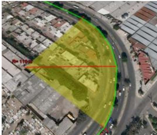
**Figura 10. Curva cerrada en el trazado**
