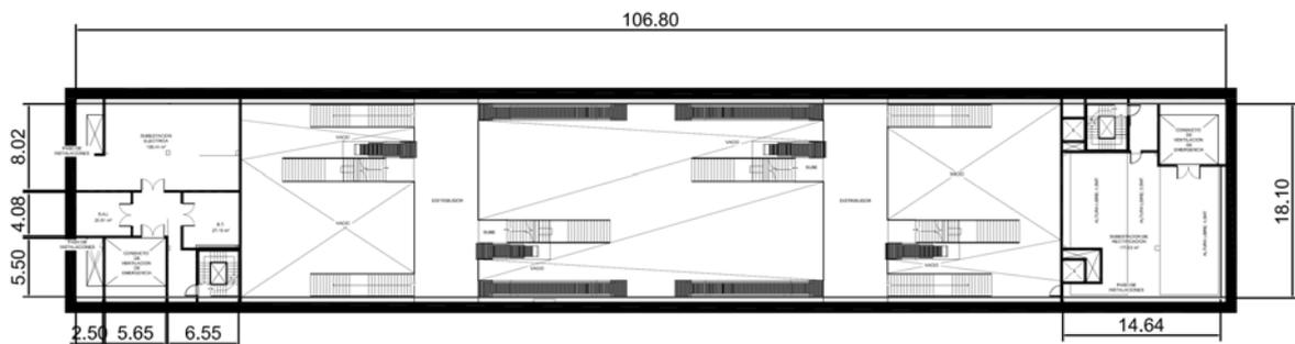
Figura 43. Planta nivel de distribuidor para estación tipo subterránea
