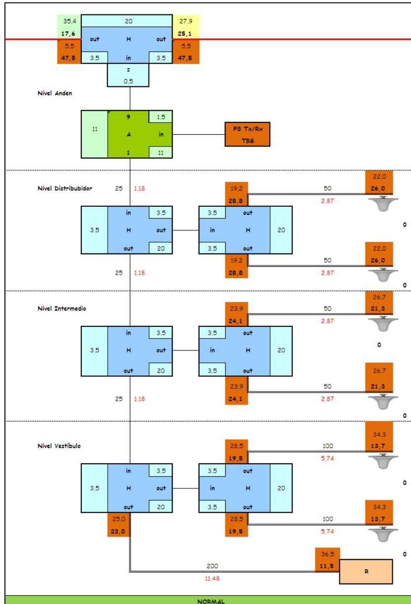
Figura 63. Distribución de Equipamiento en Estación Tipo Subterránea
