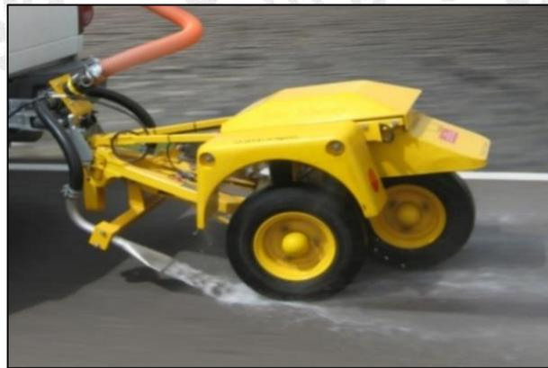
**Figura 15. Equipo Mu-Meter modelo Mk6**
